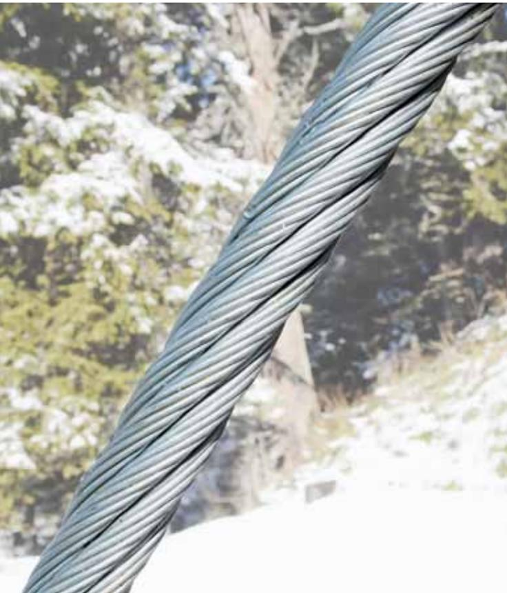
Das neue Zugseil ist ein 33 Millimeter dickes, 3600 Meter langes und 16 Tonnen schweres Litzenseil.
