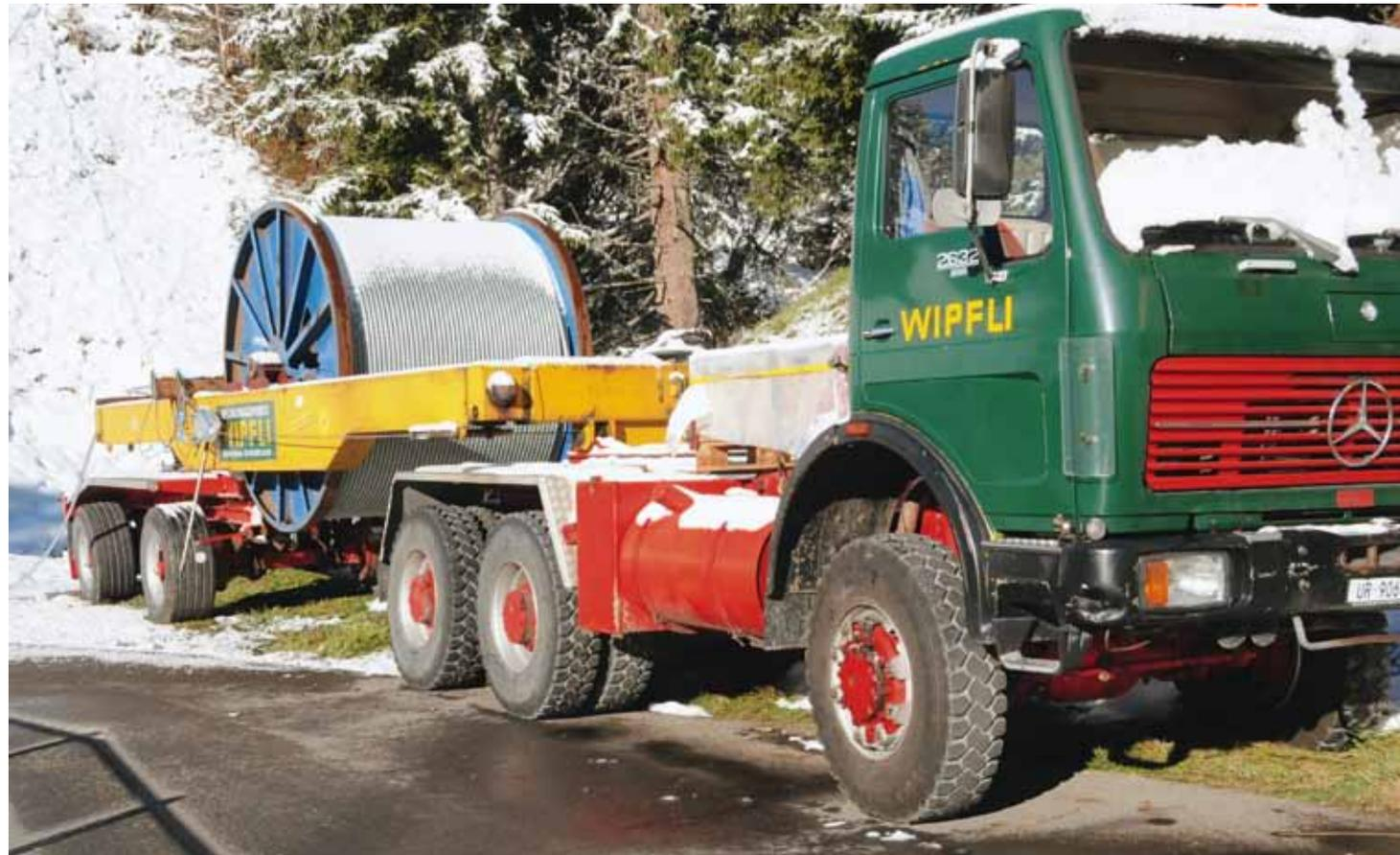
Ein Sattelschlepper transportiert das auf eine Trommel aufgerollte Seil nach Mürren.
